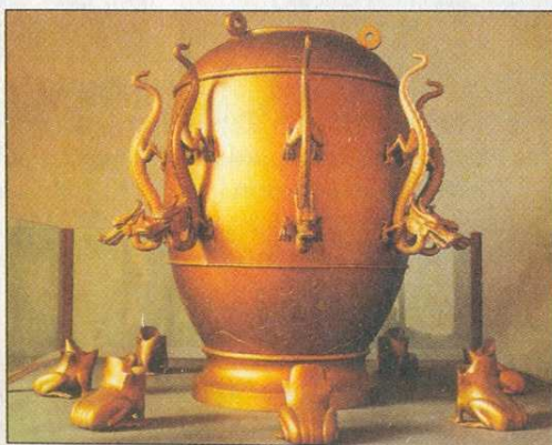
Китайський прилад для визначення коливень земної кори. Під час землетрусу із пац металевих драконів у розкриті пащечки пустотілих жабок, розташованих навпроти, дзвінко падали кульки
